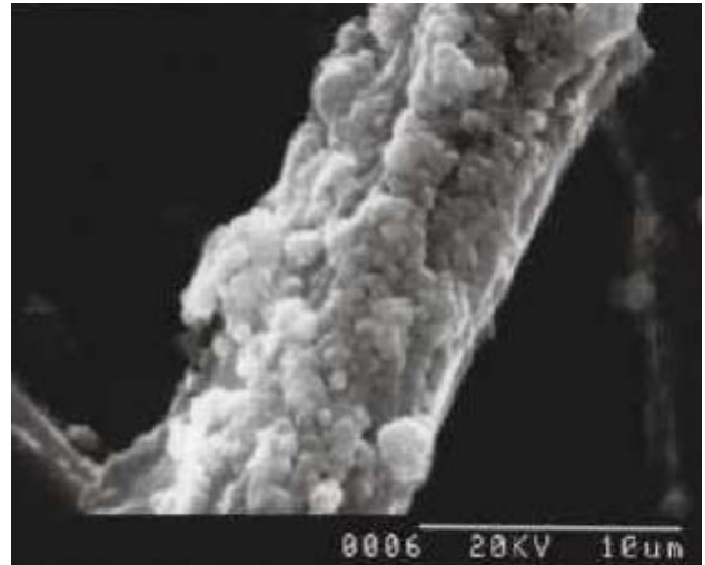
写真 リン酸エステル化，室温1週間のCa(OH) 2 処理後SBF溶液に10日間浸漬したキチン繊維上のリン酸カルシウム
